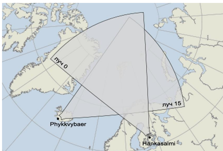
Рис. 1. Схема расположения и секторов обзора радаров SuperDARN CUTLASS.
