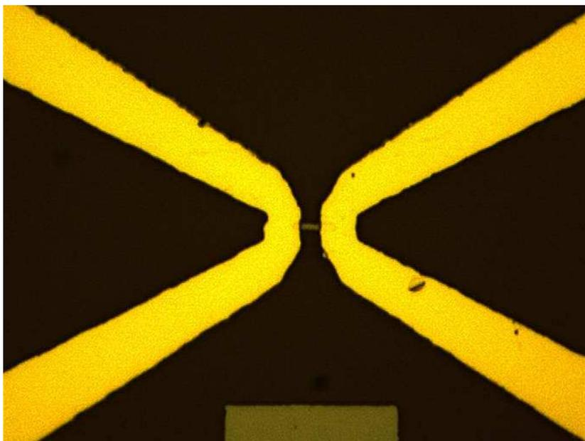
Рис. 1. Фотография центральной части тестовой структуры, сделанная в оптическом микроскопе. Видены ниобиевый мостик размером  $2 \times 1$  мкм и золотые подводящие контакты.
