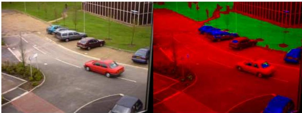
Рис.1. Пример работы фильтра предварительной обработки перед сегментацией кадра. Результат последующей сегментации будет семантически неправильным.
