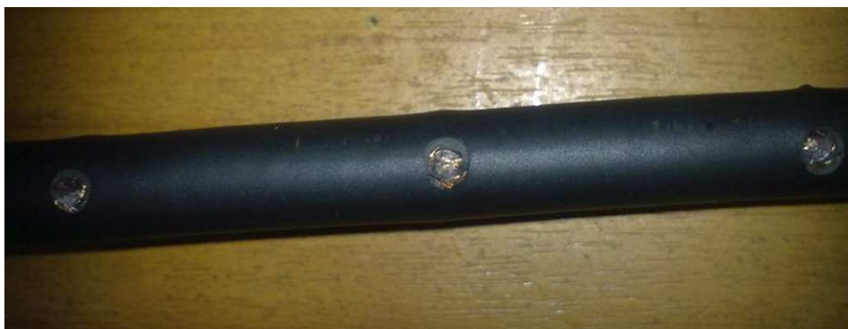
Рис. 6. Брэгговская СВЧ-структура на коаксиальном кабеле RG213
