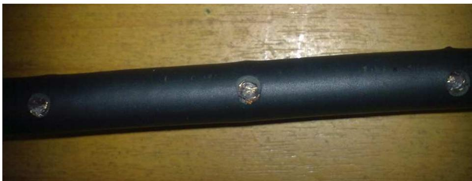
Рис. 6. Брэгговская СВЧ-структура на коаксиальном кабеле RG213
