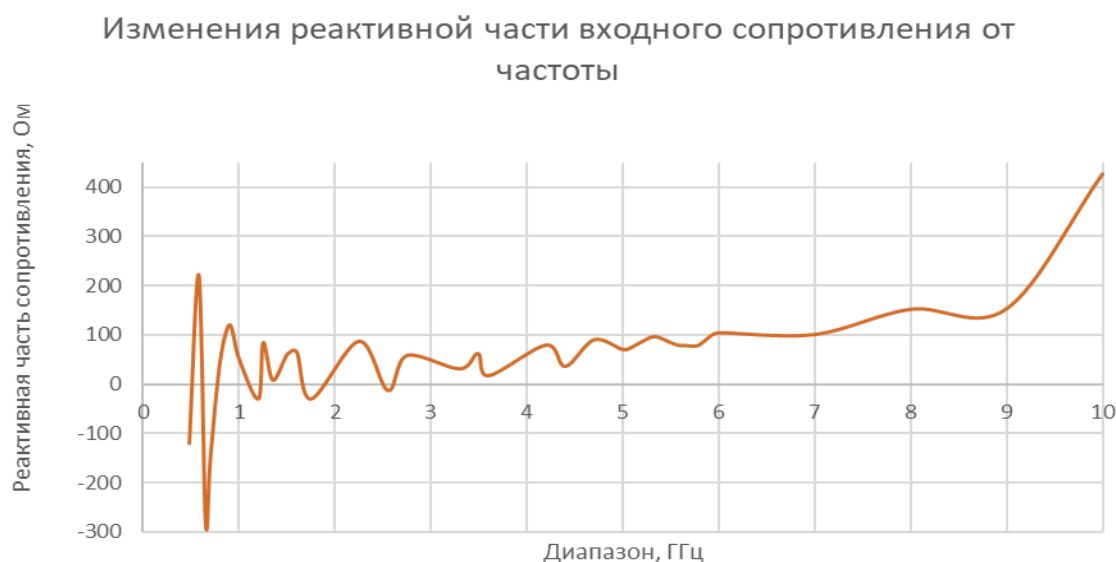
Рис. 6. Диаграмма изменения входной части реактивного сопротивления от частоты.
