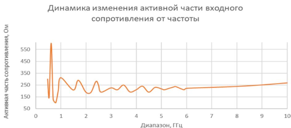
Рис. 5. Диаграмма изменения входной части активного сопротивления от частоты.
