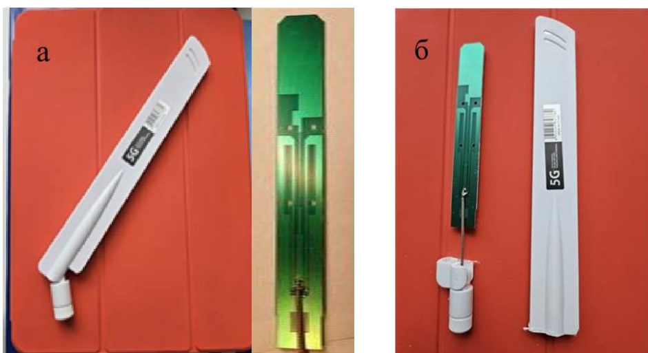
Рис. 1. Фотографии образцов печатной антенны CTRF-ANTENNA-AP-60600-13223-SMA: а – в корпусе, и б – без корпуса.
