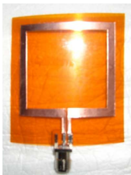
Рис.14. Образец антенны из медной фольги на пленке полиимида
