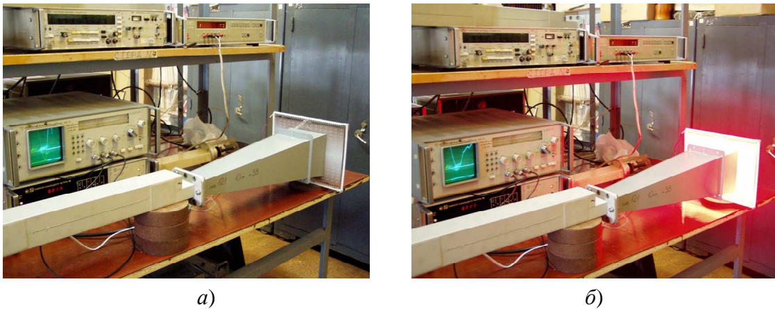
Рис 9. Измерение частотной зависимости коэффициента отражения электромагнитной волны от экрана ( а - СДП-2 выкл., б – СДП-2 вкл.)
