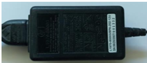
Рис. 1. Тестовый импульсный источник электропитания
