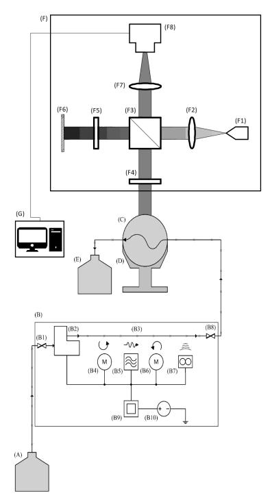
Рис.1. Схематичное описание проводимых экспериментов по формированию потоков со сложной структурой. Перечень элементов на схеме: А – емкость с кровеимитирующей жидкостью; В – формирователь пульсирующих потоков; С – фантом сетчатки глаза, D – подставка для фиксации тканеимитирующего фантома с кровеносным сосудом; Е – емкость для отработанной кровеимитирующей жидкости; F – ОКТ-система; G – компьютер для обработки данных и визуализации полученных результатов
