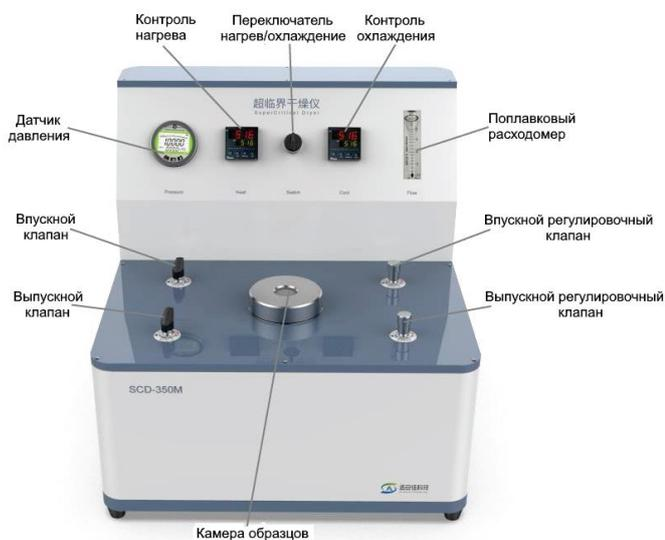
Рис. 6. Установка SCD-350M сушки в критической точке углекислоты.
