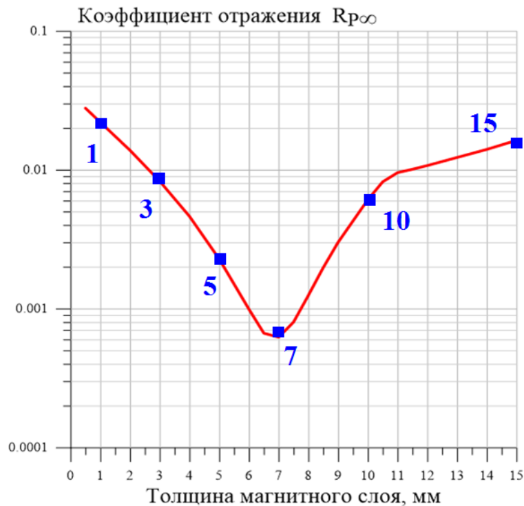
Рис. 4. Коэффициент отражения по мощности R_{p\infty} от бесконечной плоской поверхности металла с пирамидальным покрытием в зависимости от толщины магнитного подслоя.
