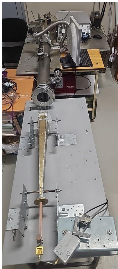
Рис. 2. Фотография спектрометра диапазона частот 75-110 ГГц.
