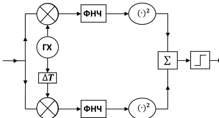
Рис. 1. Структура приемника огибающей с опорным генератором хаоса, где ГХ - опорный генератор хаоса,  $\Delta T$  - задержка,  $\otimes$  - перемножитель, ФНЧ - фильтр нижних частот,  $(\cdot)^2$  - квадратичный детектор,  $\Sigma$  - сумматор,  $\Gamma$  - пороговое устройство.
