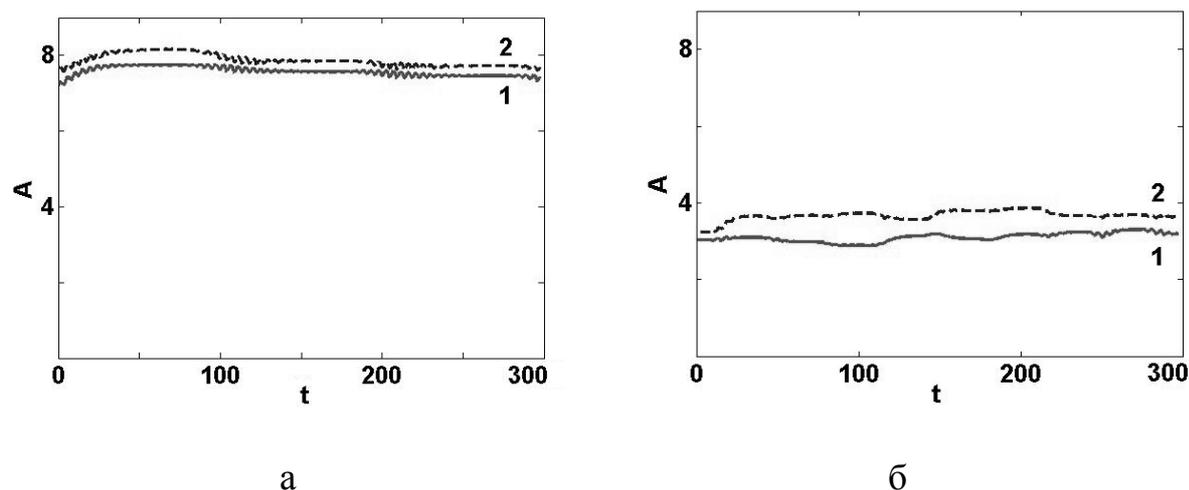
Рис. 2. Уровень сигнала на выходе приемника при приеме импульса в приемнике с опорным генератором и в приемнике с квадратичным детектором при разных значениях параметров и начальных условий в передатчике и приемнике: (а) - широкополосный случай, (б) - сверхширокополосный случай.
