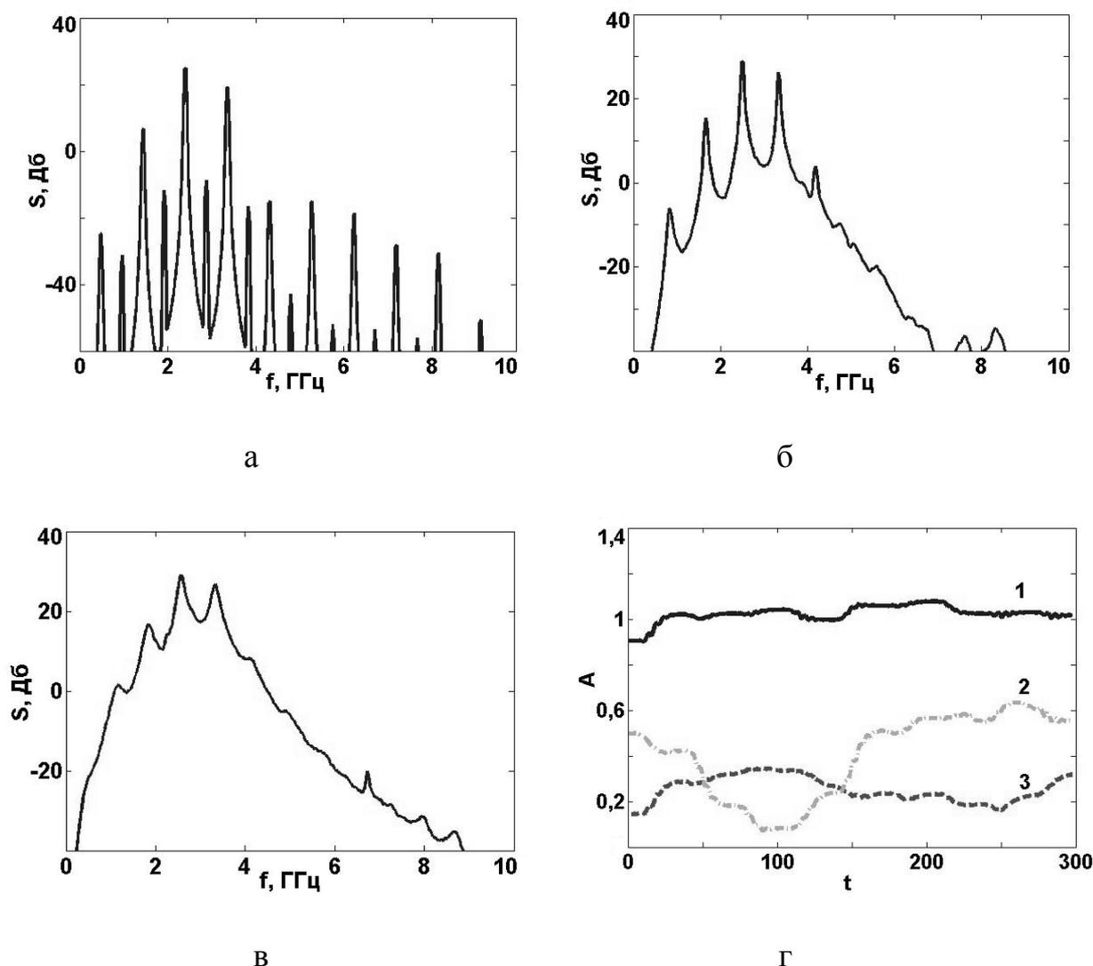
Рис. 3. Спектры мощности колебаний для значений коэффициента усиления  $m$  равное 10 (а), 30 (б), 70 (в) и сравнение уровней сигналов на выходе приемника при приеме импульса (г).
