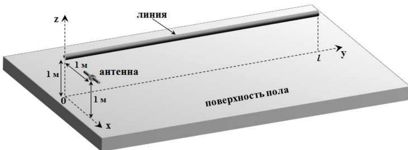
Рисунок 2 – Схема размещения излучающей антенны перпендикулярно проводной линии
