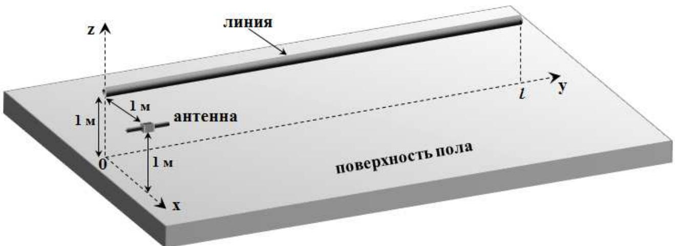
Рисунок 1 – Схема размещение излучающей антенны параллельно проводной линии
