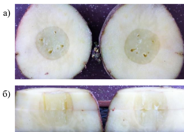
Рис. 5. Результаты нагрева имитатора биполярной электродной системой из 4-х электродов: поперечный (а) и продольный (б) срезы.
