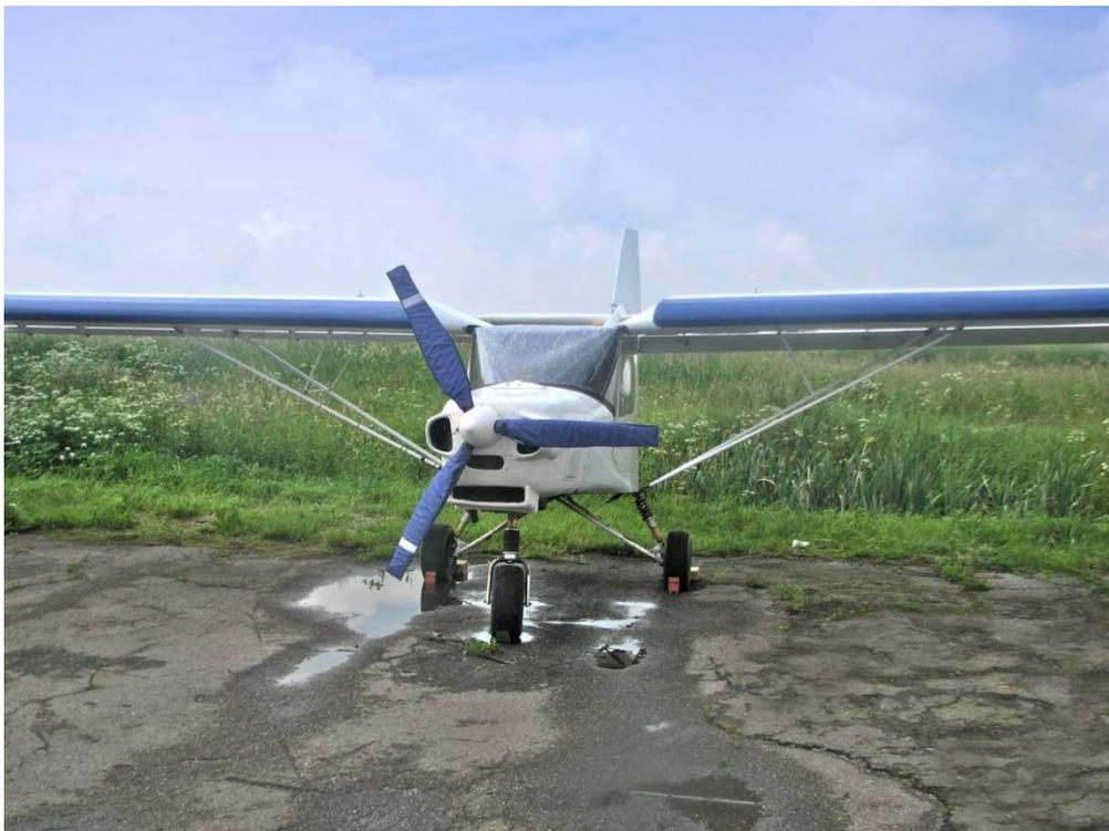
*Рис.1 - Самолет STOL-701, используемый как летательный аппарат для комплекса подповерхностного ЭМИ СШП зондирования. Технические характеристики STOL-701: размах крыла – 8.23 м; площадь крыла – 11.33 м<sup>2</sup>; вес (пустой) – 209 кг; дальность – 465 км; крейсерская скорость - 140 ; скорость сваливания – 46.5 км/ч*
