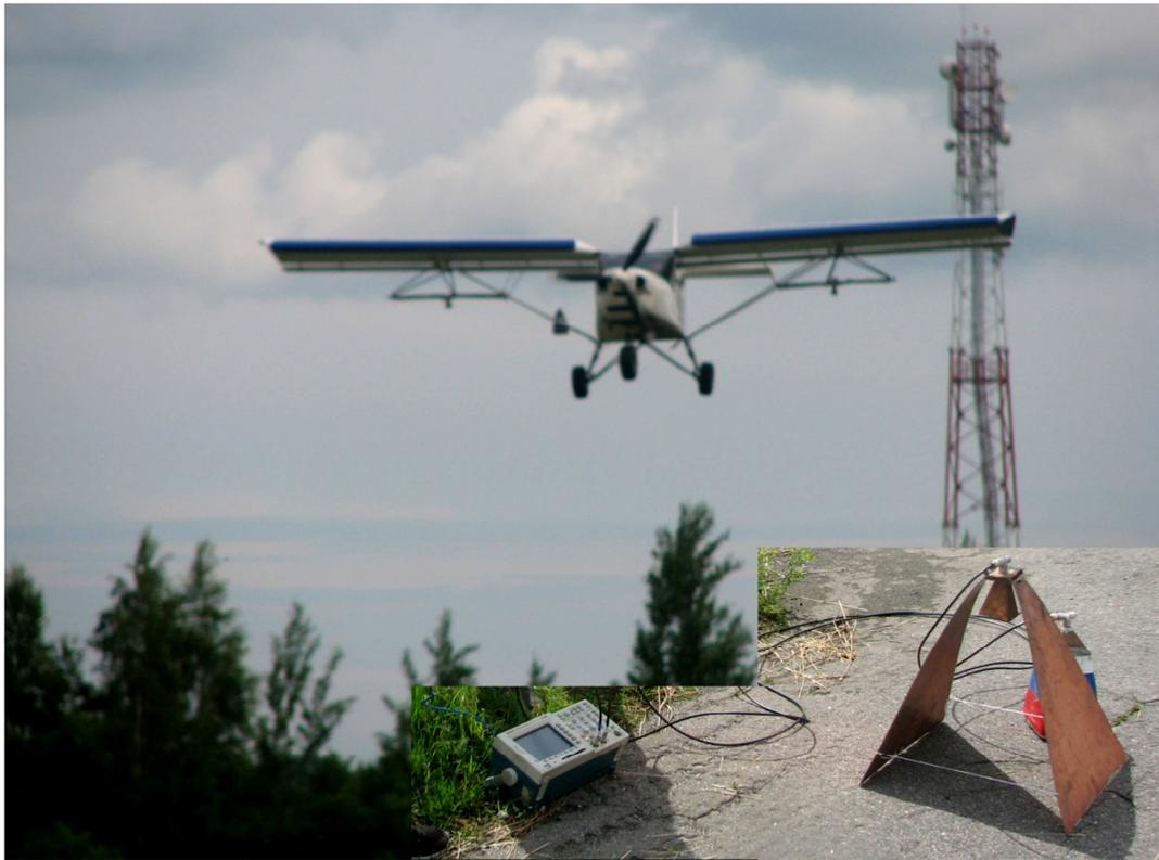
Рис.4 - Измерение ДН приёмных антенн «облётным методом». Высота полёта 20 м; 50 м; 90 м. Скорость 90 км/ч. Справа внизу - приёмник и антенна м-диапазона на ВПП
