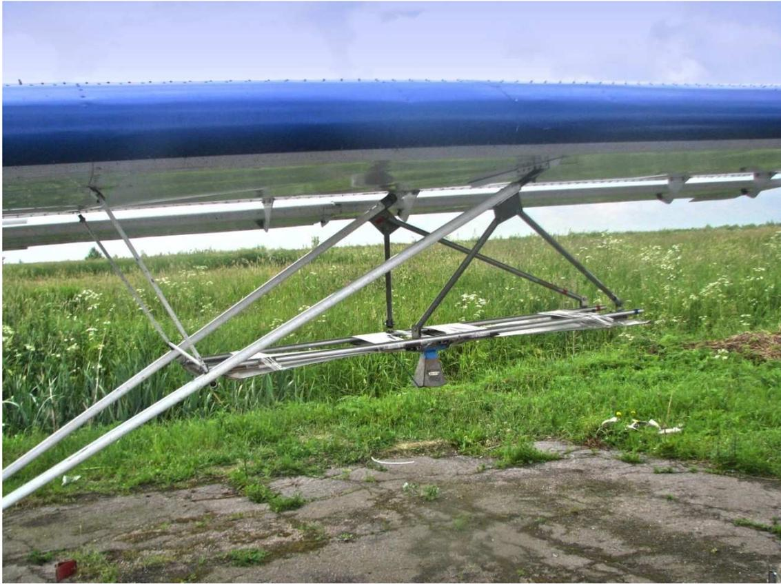
Рис.2 - Размещение антенны под крылом самолета STOL-701. Крепящие антенну металлические тяги электрически развязаны с приёмной и передающей поверхностями антенны
