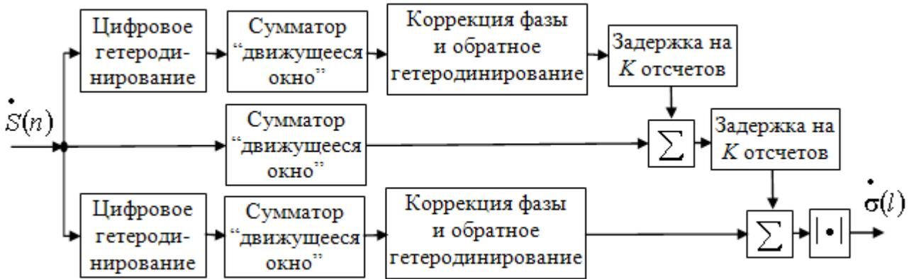
Рис. 2. Структура алгоритма формирования РЛИ методом кусочно-линейной аппроксимации для трех сегментов.
