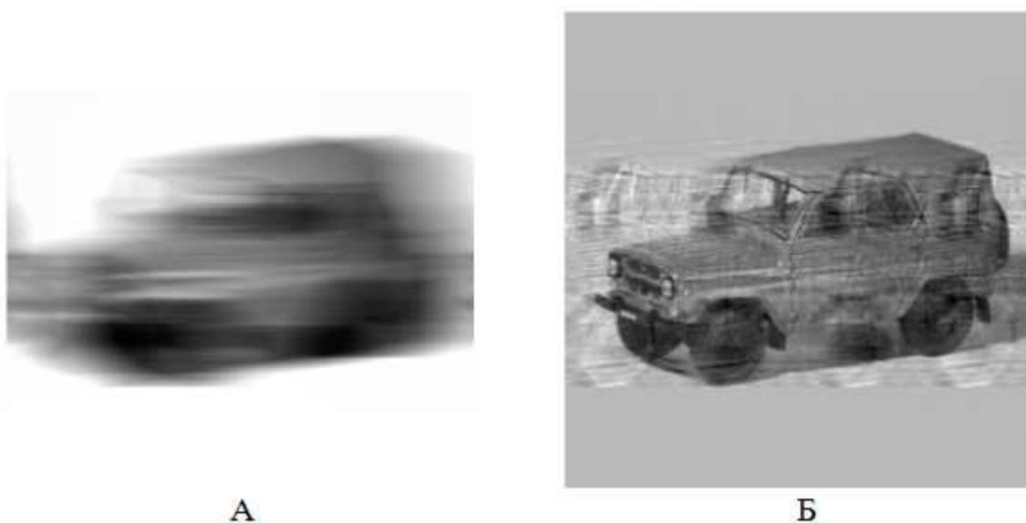
Рис.5. А – изображение, полученное после интерполяции из рис.1Б, Б - результат восстановления изображения рис.5А с помощью АМОИ (ширина полосы затенения равна 40).
