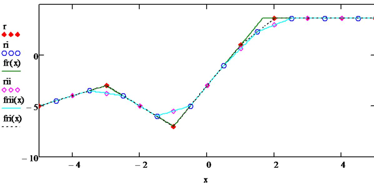
Рис.5. Графики функции (рис.1) (зелёная линия) с результатами линейной интерполяции и измеренные значения с шагом  $d=1$ . Чёрный пунктир – 1 интерполяция по измеренным узловым точкам (красные ромбы). Голубая линия – 2 интерполяция по вычисленным точкам (синие окружности). Фиолетовые ромбы – результаты 2 интерполяции в измеренных точках. Узловые точки для 2 интерполяции отстоят от узловых точек 1 интерполяции на  $m d$ , где  $m=0,5$ .
