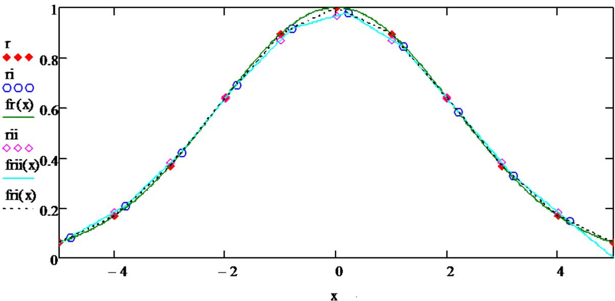
Рис.12. Графики функции (1) (зелёная линия) с результатами линейной интерполяции и измеренные значения с шагом  $d=1$ . Чёрный пунктир – 1 интерполяция по измеренным узловым точкам (красные ромбы). Голубая линия – 2 интерполяция по вычисленным точкам (синие окружности). Фиолетовые ромбы – результаты 2 интерполяции в измеренных точках.
