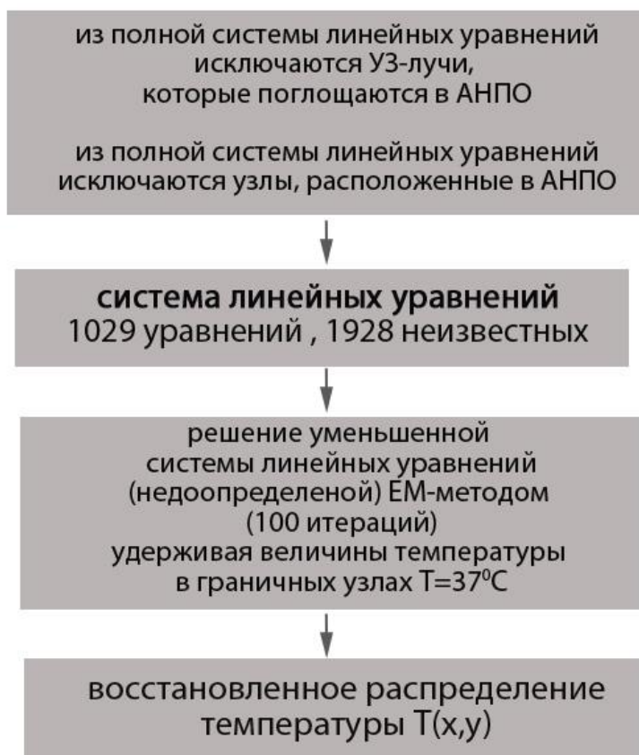
Рис. 8. Схема восстановления температурного распределения EM-методом
