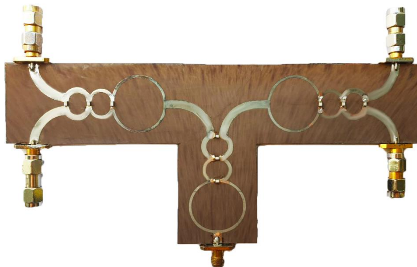
Рис. 3. Изображение экспериментального макета пятипортового трёхзвенного сумматора Уилкинсона, изготовленного по результатам моделирования
