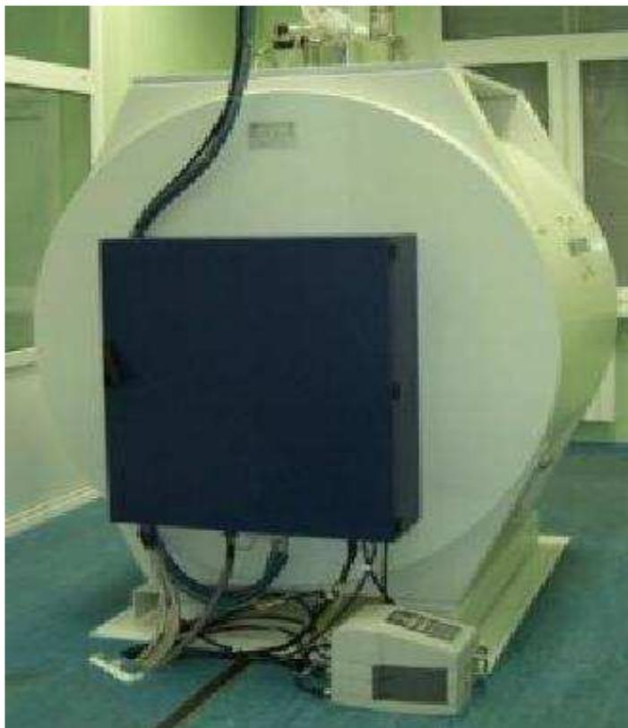
Рис. 1. Внешний вид 7-Тл биоспектротома Bruker BioSpec 70/30 URS.
