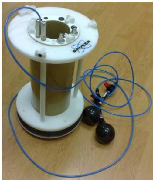
Рис. 2. Катушка для получения  $^1\text{H}$ - и  $^{19}\text{F}$ -МРТ-изображений.
