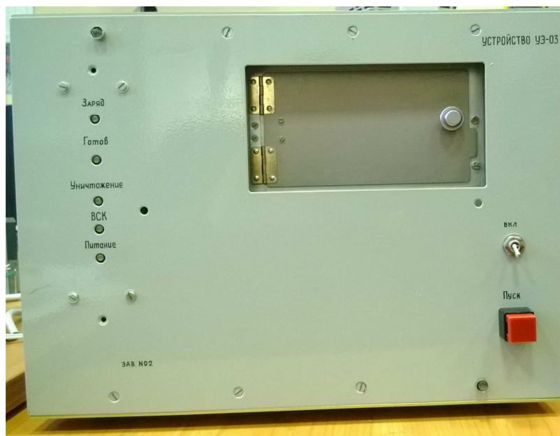
Рис. 5. Общий вид устройства экстренного уничтожения информации с полупроводниковых электронных носителей.
