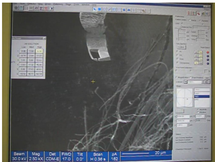
Рис. 24. Разрушение паяльного соединения при механическом воздействии.
