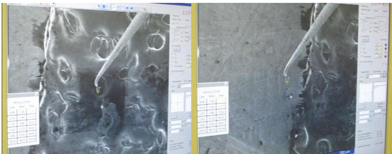
Рис. 6. Перемещение пучка УНТ диаметром 3-4 мкм на фоне предметного столика ионного сканирующего микроскопа
