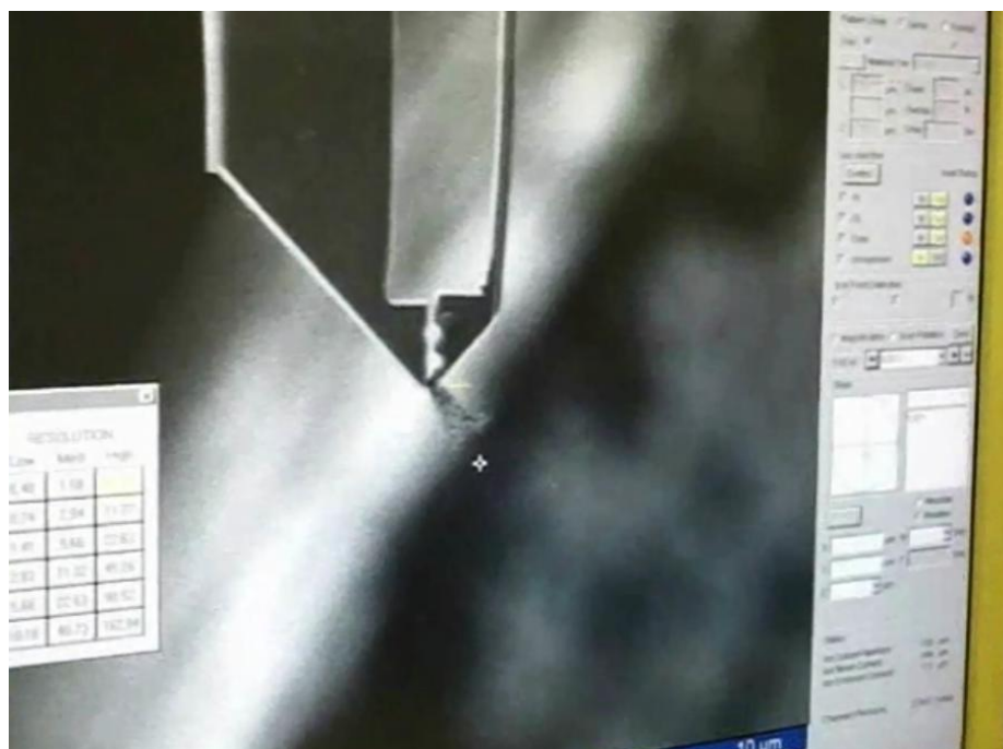
Рис. 8. Манипулирование углеродными нанотрубками при помощи нанопинцета
