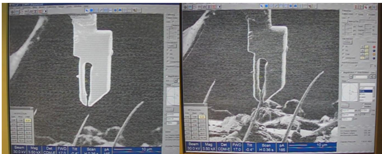
Рис. 12. Подвод объекта манипулирования в створ рабочей части нанопинцета (слева), зажим объекта манипулирования нанопинцетом (справа).
