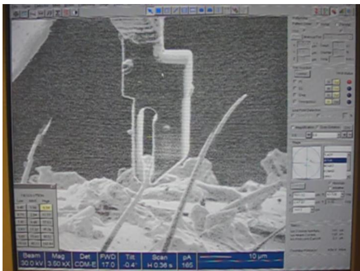
Рис. 27. Деформирование волоса нанопинцетом
