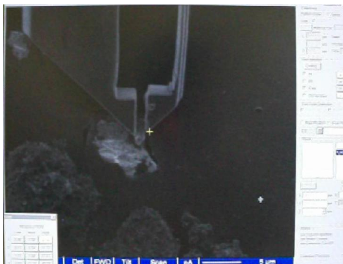
Рис. 28. Зажим микрообъекта, находящегося на клейкой подложке
