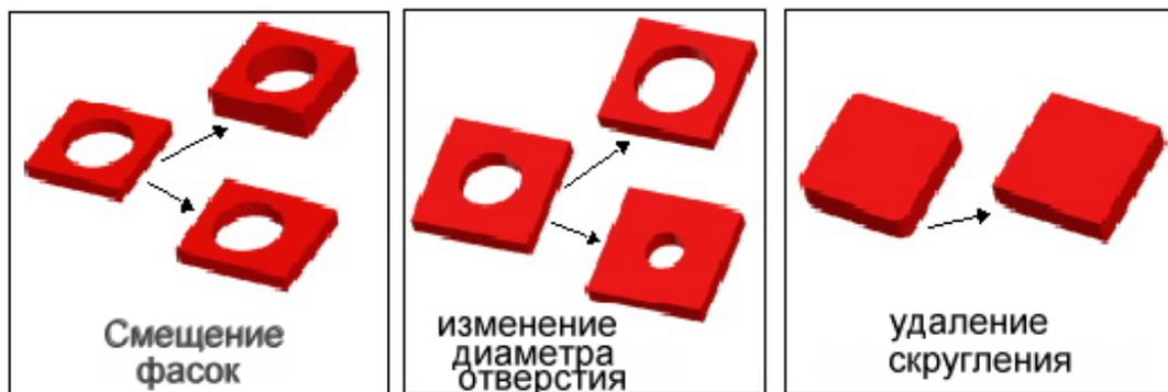
Рис. 3.31. Создание трехмерных объектов, используя операции вытеснения
