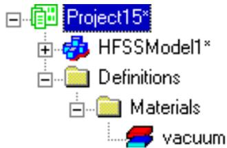
Разверните значок конструкции в дереве проекта, чтобы рассмотреть все данные о модели, включая ее граничные условия и материалы, поля в структуре и информацию постобработки.
