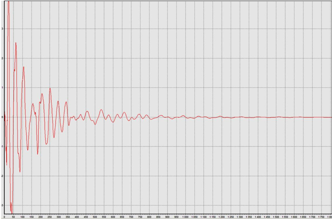
Рис. 1 – Отраженный сигнал, принятый на бетонной плотине Бурейской ГЭС приемной антенной м- диапазона (развёртка – 0.8 нс/точка)
