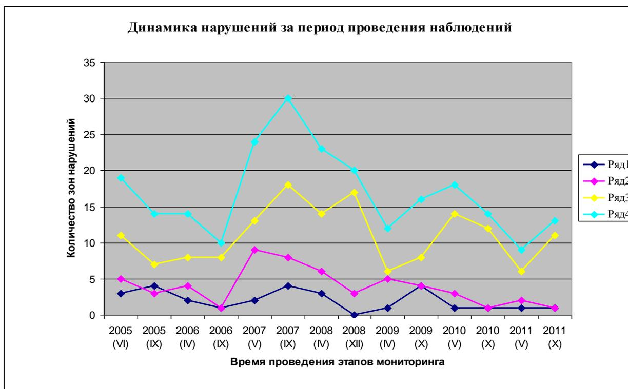
**Рис. 35** – Графики количества проявлений различных нарушений в грунтах в пределах объединенного контура участков I степени влияния на просадки дневной поверхности. Ряд 1 – зоны суффозии; ряд 2 – зоны интенсивного разуплотнения грунтов; ряд 3 – зоны слабого разуплотнения грунтов; ряд 4 – суммарное количество нарушений в сплошности грунтов
