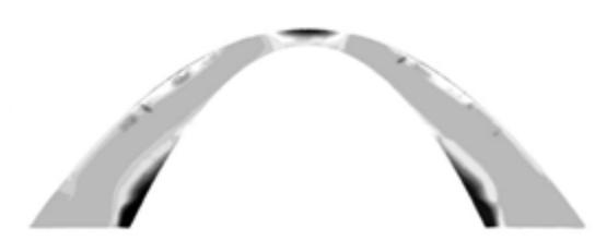
Рис. 6. Расчет прочности купольной линзы
