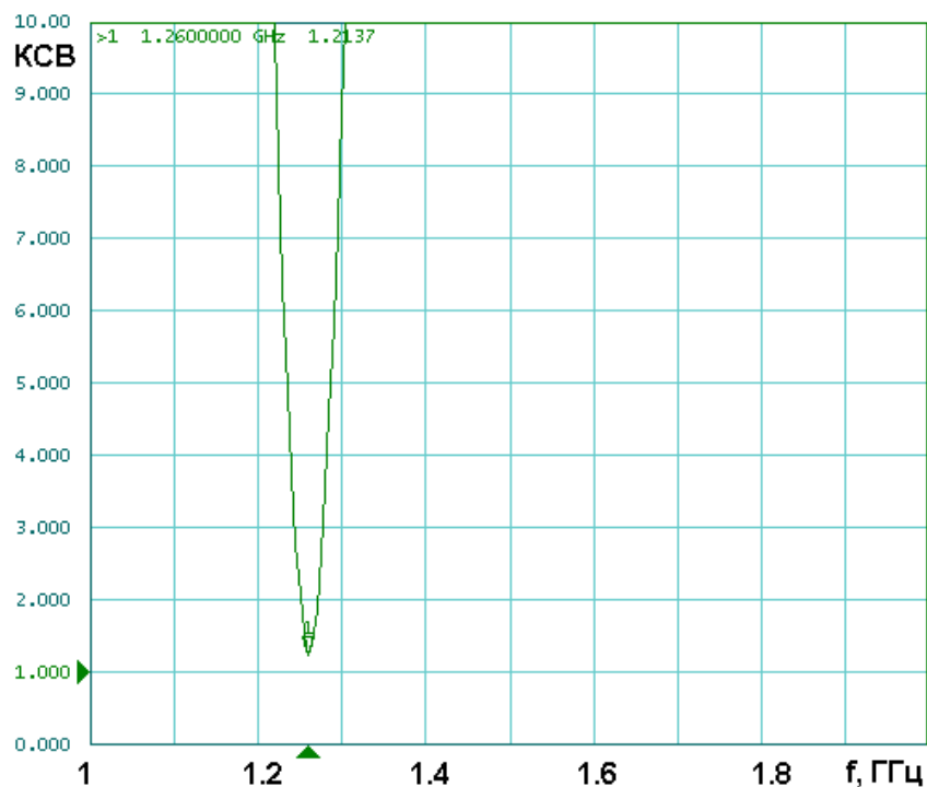
Рис. 1.7.3. Измеренная зависимость КСВ от частоты для ПА со всеми зубцами
