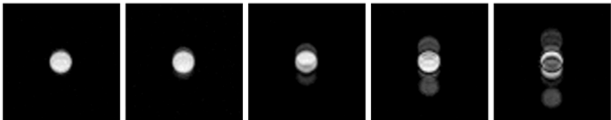
Рис. 6. МР-изображения флакона с перфтордекалином при разных значениях BW (в кГц) - слева направо: 41.6, 20.8, 11.6, 6.5, 4.4. FOV=128 \times 128 мм, N=64 .
